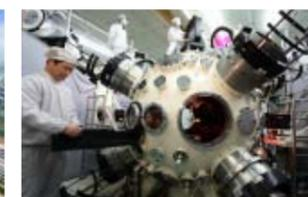
神光高功率激光实验装置-神光靶场
